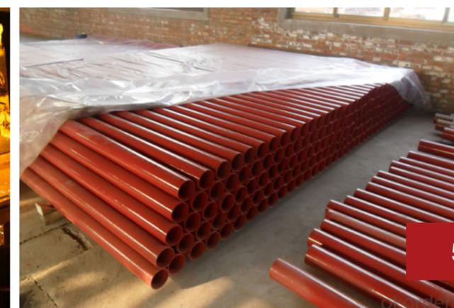
Дренажные трубы и фитинги ECK SML с наружной стороны, как требует действующий стандарт, покрываются красно-коричневым защитным слоем. Изнутри их поверхность имеет эпоксидное покрытие, которое отличается стойкостью к воздействию агрессивных сточных вод, высоких температур, а также препятствует проникновению звука.
